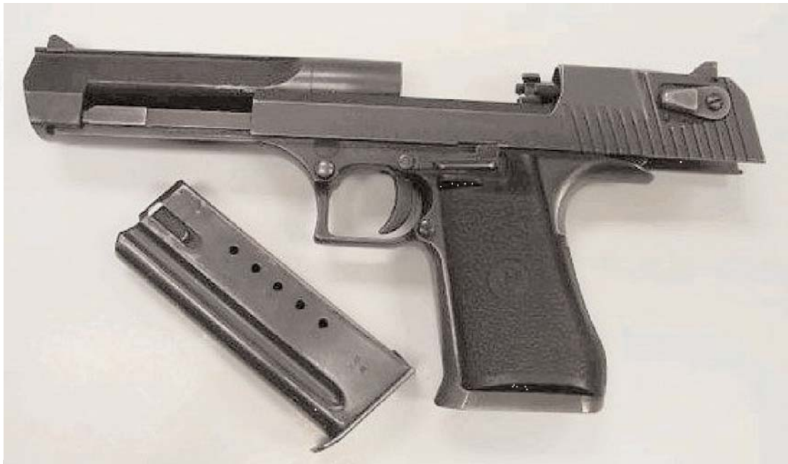
пистолет Desert Eagle mark VII, калибър .44 Magnum. затвор фиксиран в отворено положени така че се вижда добре главичката на завъртащия затвор
