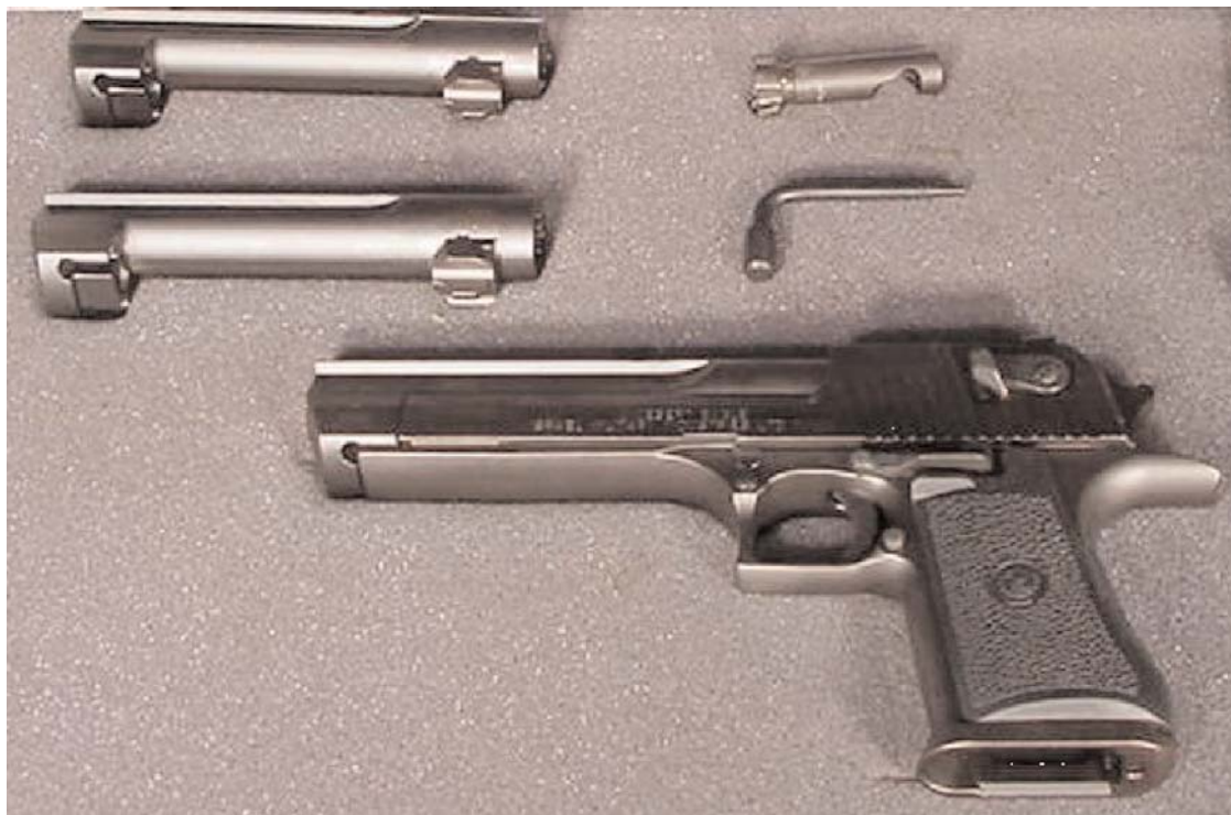
пистолет Desert Eagle Mark XIX в комплект със сменяеми стволове от разен калибър, допълнителен затвор и принадлежност для разглобяване
